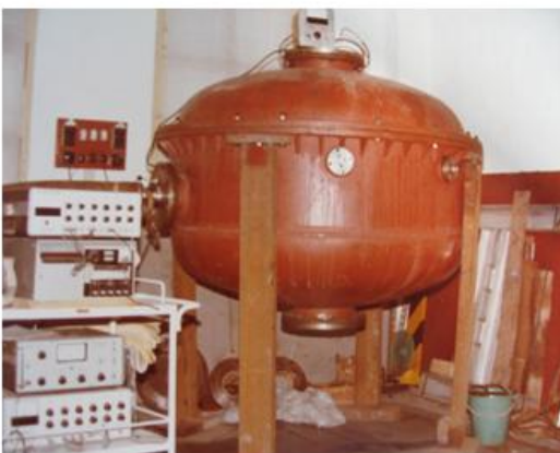
可调谐低频引力波检测装置（唐孟希）
